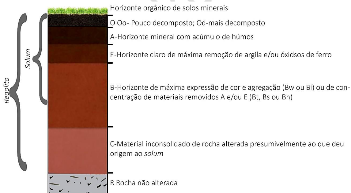
Figura 4 - Horizontes e sub-horizontes em perfil de solo.
